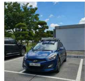
그림4 로봇센서들이 장착된 차량형 센서시스템
